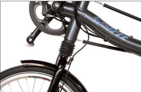
Die Federung des Vorderrades ist im Steuerkopf des Rades integriert.
