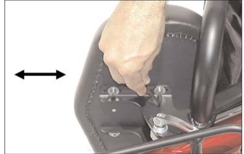
Das Sitzkissen kann nach Lösen der vier Innensechskantschrauben auf der Unterseite nach vorne oder hinten verschoben werden.
