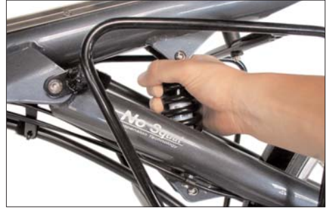
Drehen des Einstellrings zur Regulierung der Federvorspannung.
