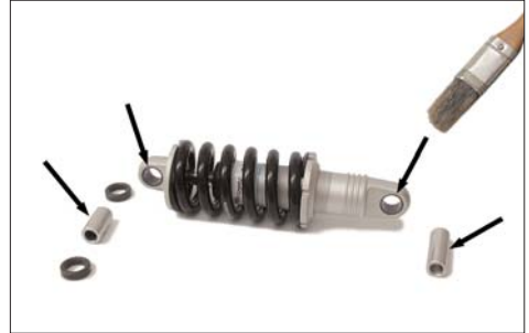
Die Lagerbuchsen des Federelementes müssen mit Fett geschmiert werden.
