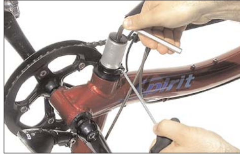
Einstellen des Steuersatzes mit aufgeschobener Einstellhülse
