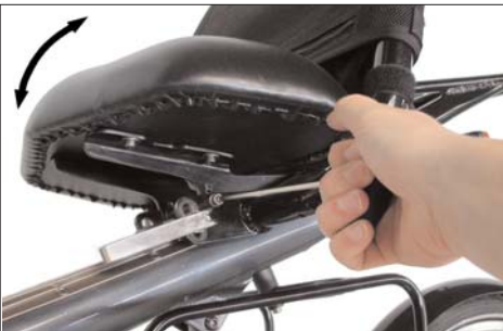
Lösen der Klemmschraube links unter dem Sitzkissen
