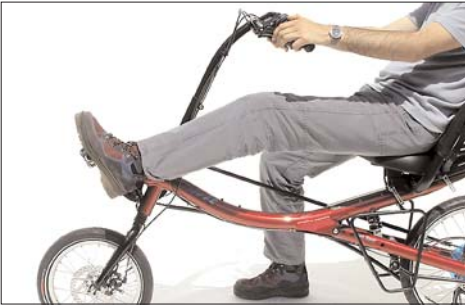
Der Sitz wird so eingestellt, dass das Knie beim Fahren gerade nicht maximal durchgestreckt wird.
