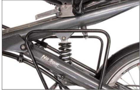
Federelement an der Hinterradschwinge des Spirit.
