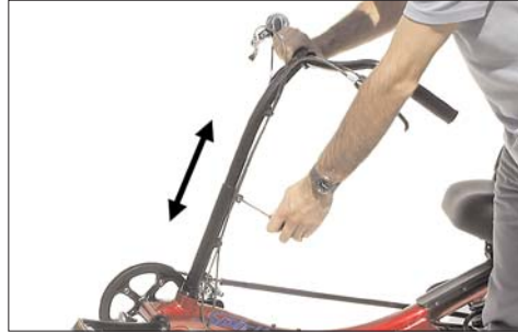
Durch Lösen der Klemmschraube kann der Lenker in der Höhe verstellt werden.
