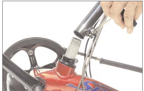
Nach dem Lösen der Vorbauklemmschraube kann der Vorbau abgezogen werden.
